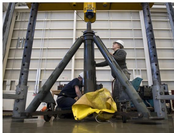
ユニバーサル・ジャッキ・テスターに60トンのジャッキをはめる作業で誘導する第374整備中隊、航空宇宙地上機材小隊の技師ソマー・ラックス一等空兵。60トンのジャッキは、C-17グローブマスターのような大型機用に作られており、安全性と即応態勢を整えるため、航空宇宙地上機材小隊による点検が毎年必須となっている。
